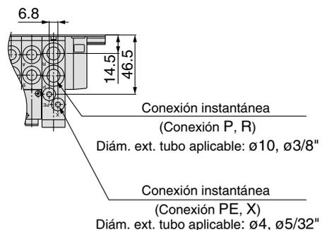
**Pilotaje externo/Silenciador incorporado**
