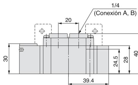
**Serie SYA7000: Montaje con conexiones neumáticas sobre la válvula**
