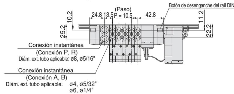
SS5Y3-45S1 □ D- Estaciones B-C4, N3 C6, N7-Q (para unidad SI tipos C, Q, R1, R2 y V)
