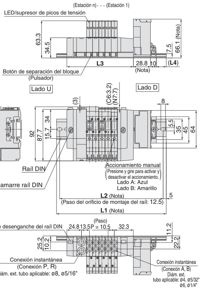
SS5Y3-45S □ - Estaciones B-<sup>C4, N3</sup>/<sub>C6, N7</sub> -Q (Para unidad SI tipos C, Q, R1, R2 y V)
