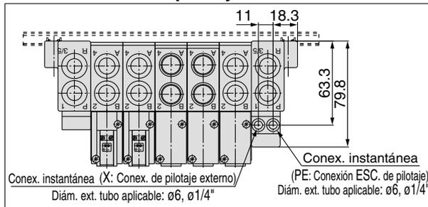
\* La conexión de descarga de aire en el modelo con silenciador incorporado y la posición de extracción del pilotaje externo se encuentran en el lado D.
