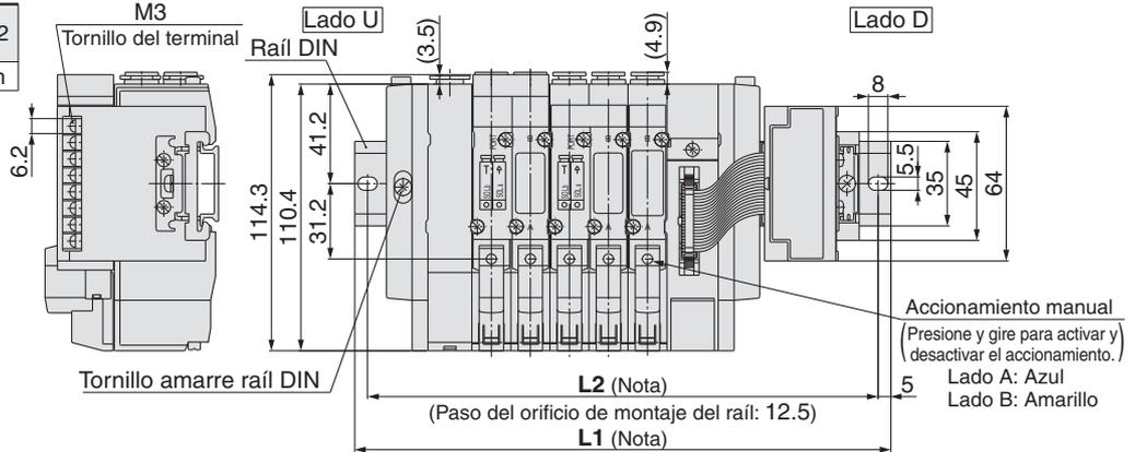
Nota) Las dimensiones L1 a L4 de SS5Y5-45S1 □ D- Estaciones D-<sup>C4, N3</sup><sub>C6, N7</sub> son las mismas que SS5Y5-45S1 □ D- Estaciones U-<sup>C4, N3</sup><sub>C6, N7</sub>.
