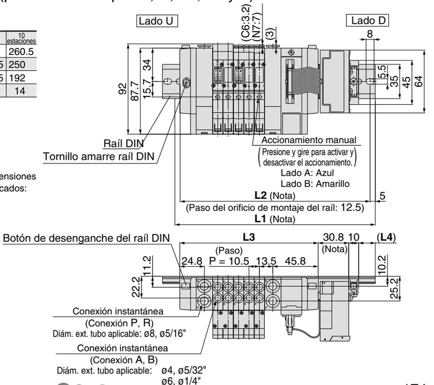
**SY5000: Unidad de transmisión serie/Tipo cableado interno**
