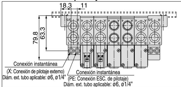
\* La conexión de descarga de aire en el modelo con silenciador incorporado y la posición de extracción del pilotaje externo se encuentran en el lado B (ambos lados).
