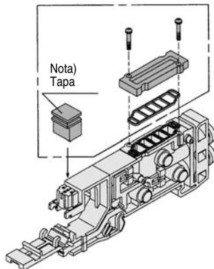
Mediante la instalación de un disco de separación de ALIM. en la vía de alimentación de presión de una válvula de bloque, se pueden suministrar dos o más presiones diferentes, altas o bajas, a un solo bloque.
