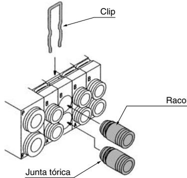
El tipo 45 permite cambiar los tamaños de las conexiones A y B sustituyendo los racores del bloque. Tras retirar la válvula, extraiga el clip con un destornillador, etc. Para montar el nuevo racor deberá introducirlo y a continuación colocar el clip hasta que no sobresalga del bloque.
