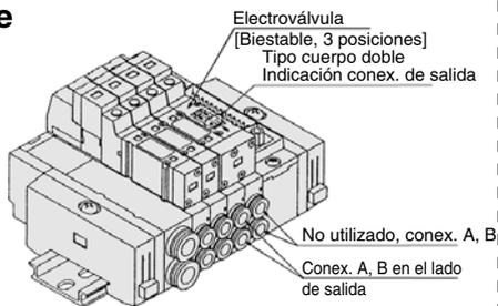
Las electroválvulas tipo plug-in consisten en una electroválvula no polar y un conector plug-in. Tenga en cuenta las siguientes referencias cuando los pida de forma separada.
