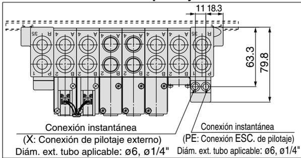
\* La conexión de descarga de aire en el modelo con silenciador incorporado y la posición de extracción del pilotaje externo se encuentran en el lado D.
