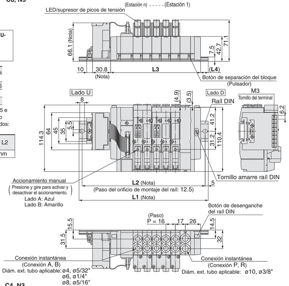
**SS5Y5-45S1□U- Estaciones B-<sup>C4, N3</sup><sub>C6, N7</sub>-Q (para unidad SI tipos C, Q, R1, R2 y V)**
