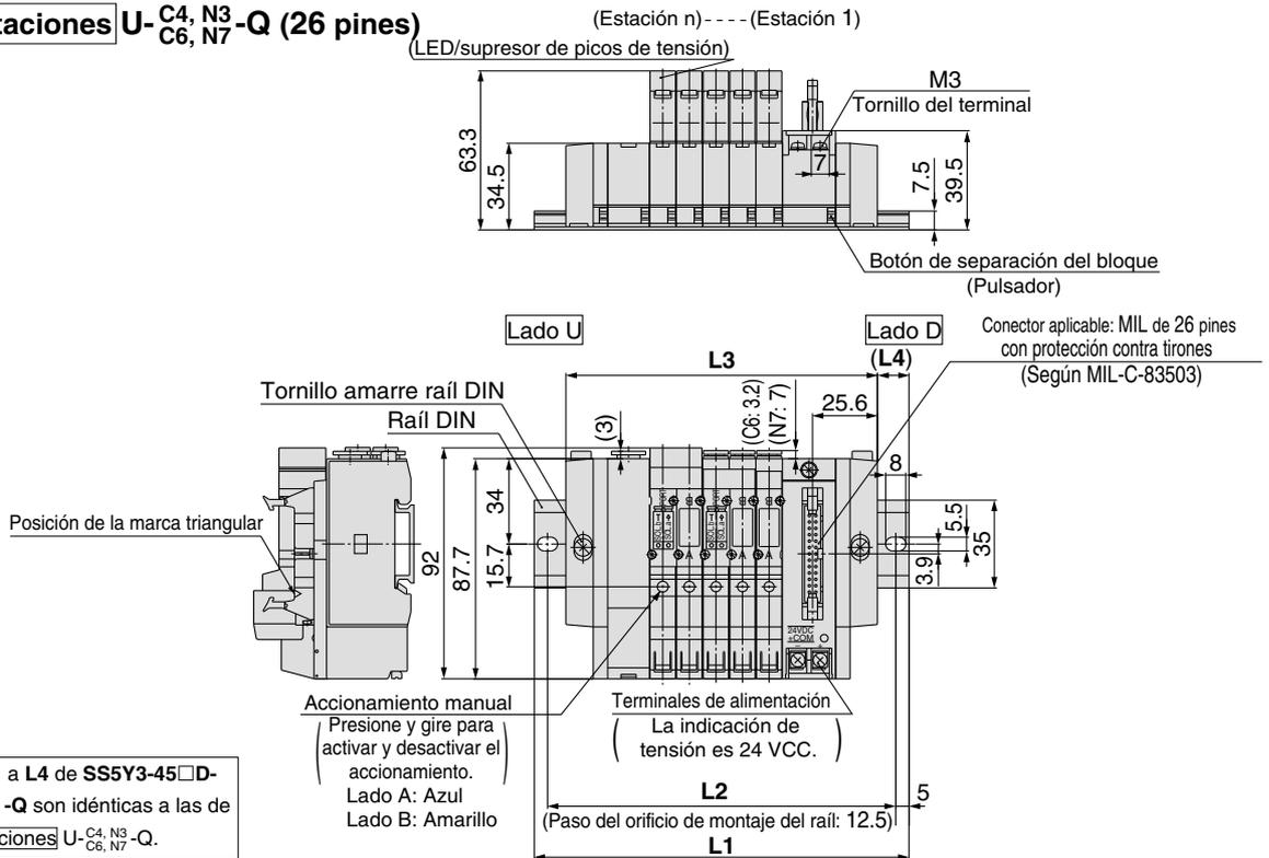
**Nota)** Las dimensiones L1 a L4 de SS5Y3-45□D- Estaciones D-<sup>C4, N3</sup>/<sub>C6, N7</sub>-Q son idénticas a las de SS5Y3-45□D- Estaciones U-<sup>C4, N3</sup>/<sub>C6, N7</sub>-Q.
