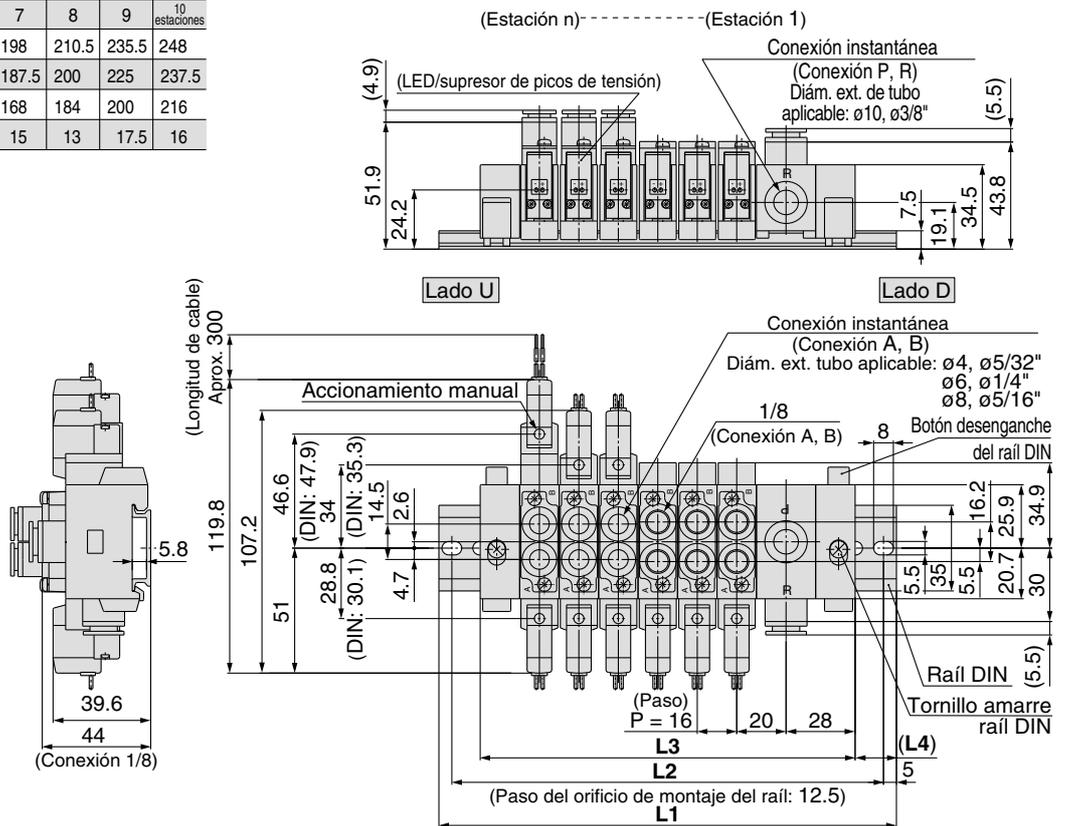
Montaje con conexiones neumáticas sobre la válvula
