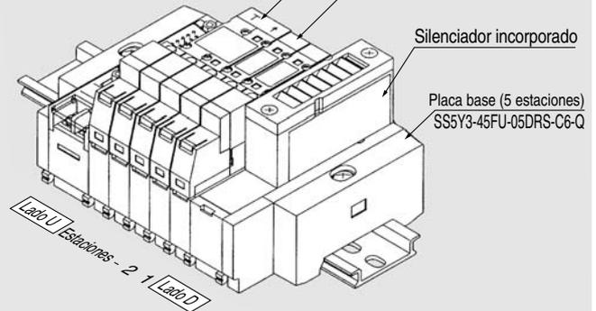
SS5Y3-45FU-05DRS-C6-Q 1 juego (Especificación pilotaje externo con ref. de silenciador incorporado)
