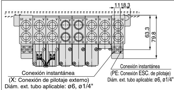
\* La conexión de descarga de aire en el modelo con silenciador incorporado y la posición de extracción del pilotaje externo se encuentran en el lado B (ambos lados).
