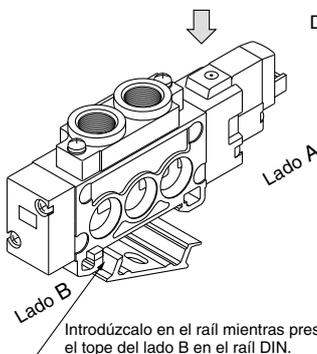
Fig. 2 Procedimiento de desmontaje del bloque
