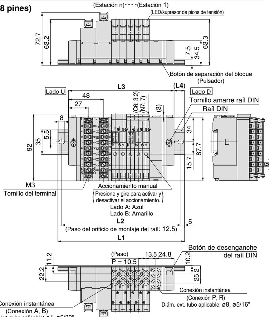
Nota) Las dimensiones L1 a L4 de SS5Y3-45T1U- Estaciones U-C<sup>4</sup>, N<sup>3</sup>, C<sub>6</sub>, N<sub>7</sub>-Q son las mismas que SS5Y3-45T1U- Estaciones D-C<sup>4</sup>, N<sup>3</sup>, C<sub>6</sub>, N<sub>7</sub>-Q.
