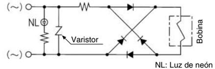
(Nota) El supresor de picos de tensión del varistor tiene una tensión residual, correspondiente al elemento de protección y a la tensión nominal. Por lo tanto, proteja el lado del controlador de los picos de tensión. La tensión residual del diodo es de aproximadamente 1V.
