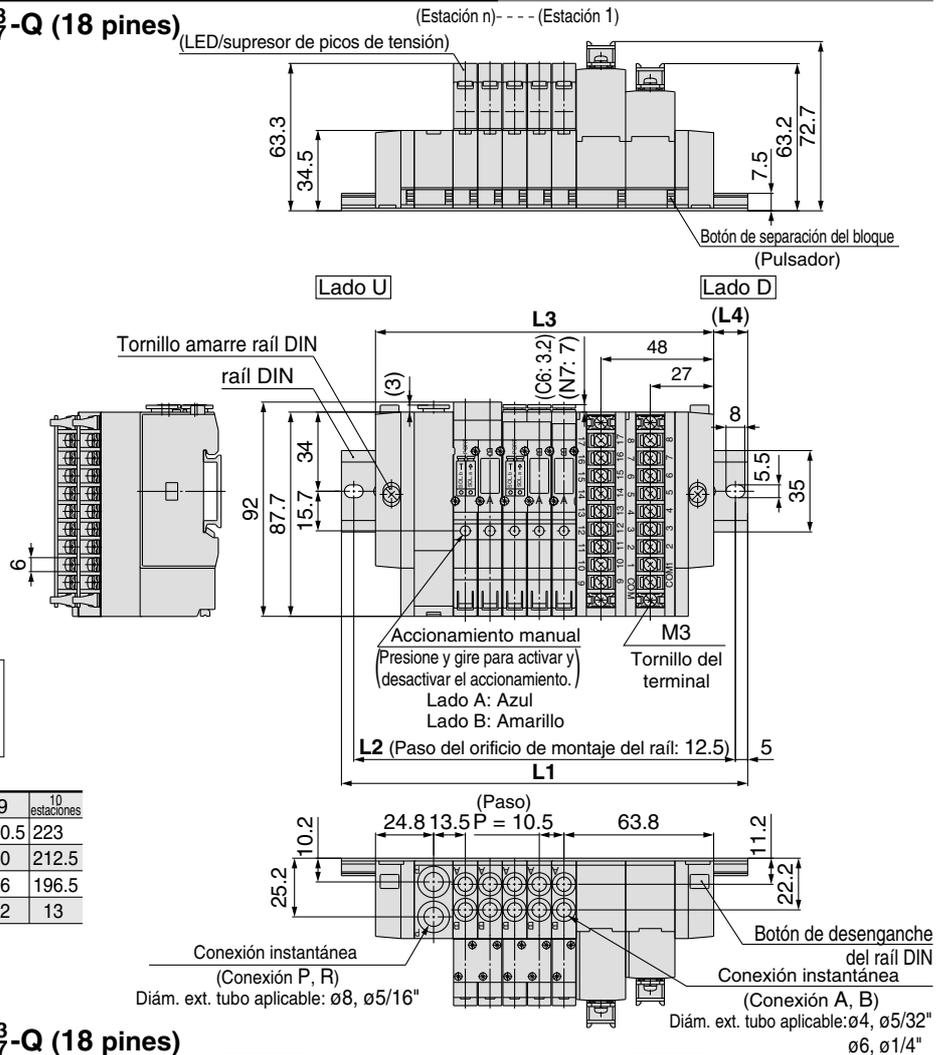
Nota) Las dimensiones L1 a L4 de **SS5Y3-45T1D- Estaciones D-<sup>C4, N3</sup>/<sub>C6, N7</sub>-Q** son las mismas que **SS5Y3-45T1D- Estaciones U-<sup>C4, N3</sup>/<sub>C6, N7</sub>-Q**.
