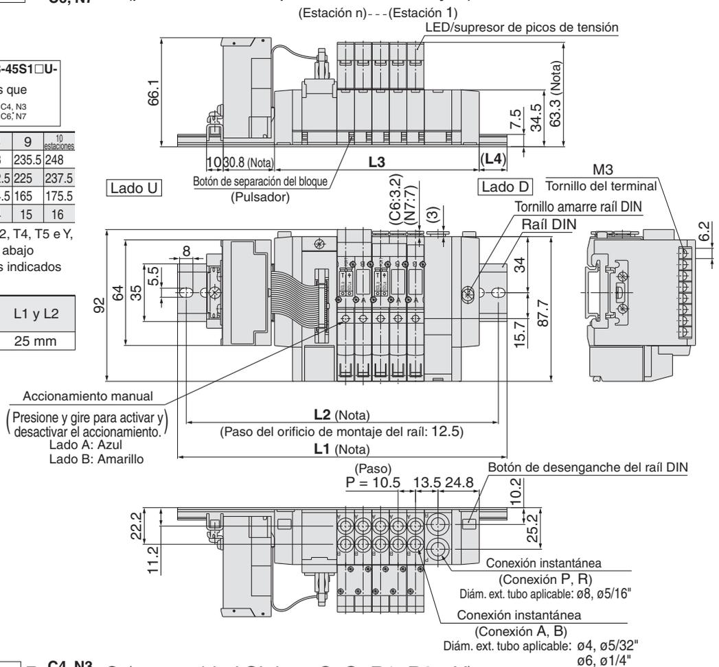
**SS5Y3-45S1□U- Estaciones B-<sup>C4, N3</sup><sub>C6, N7</sub>-Q** (para unidad SI tipos C, Q, R1, R2 y V)
