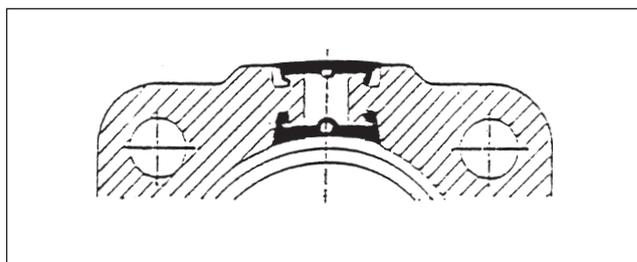
**Gruppo Pistone - Carrello** realizzato in profilato estruso in lega d'alluminio con pattini di guida in materiale termoplastico. Il pistone è corredato con guarnizioni a labbro che consentono il recupero continuo di usura; a richiesta, è possibile accessoriarlo con magneti permanenti (Serie S1).
