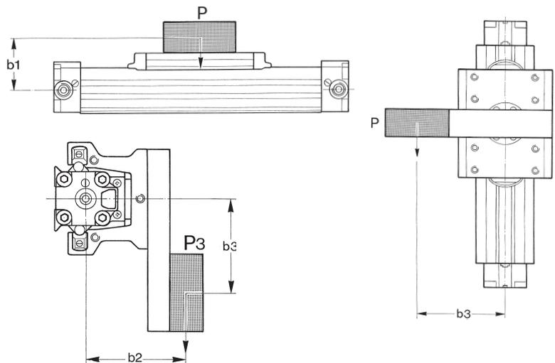
Si noti che mentre F, M1, M3 possono avere sia componenti statiche che d'inerzia, M2 è solo di tipo statico.
