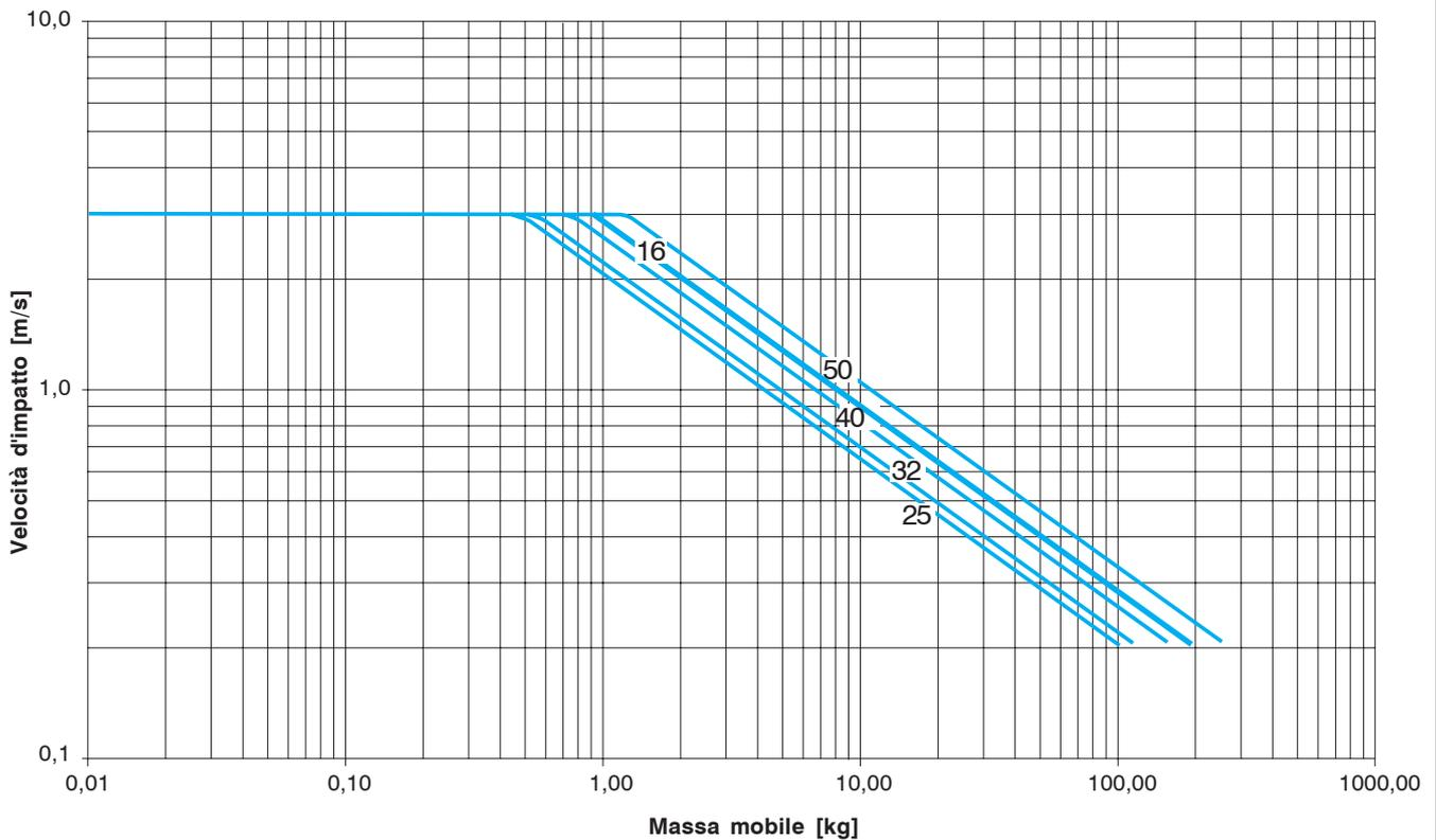
A seguito di tali considerazioni, se l'energia cinetica non è assorbibile dagli ammortizzi delle testate, e non è possibile variare i parametri (a - b - c riportati a pag. 11), occorre assolutamente applicare un deceleratore supplementare in modo da diminuire la velocità del carico prima dell'ammortizzo del cilindro;
